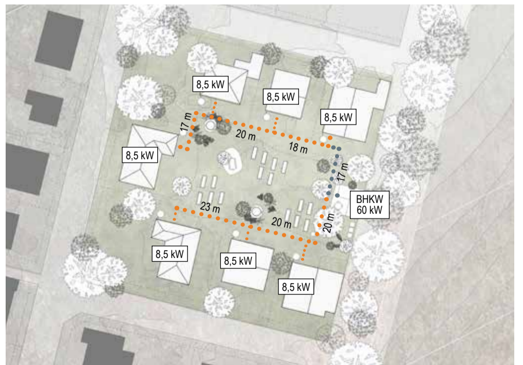
Gebäudeverband mit Mini-BHKW
